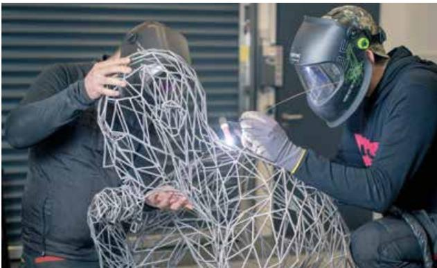
Basierend auf einem 3D-Modell und einer CAD-Zeichnung wurde ein 3D-Metall-Drucker der Berlin Industrial Group-Tochter Gefertec so programmiert, dass er aus Draht und mit Hilfe eines Lasers die von Moto Waganari entworfene Skulptur des Denkers fertigte (Foto unten).
